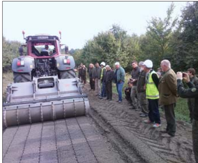
Előtörés, vontatott kalapácsfejes törőgép profilozó hengerrel (Fendt 936 traktormeghajtás)
